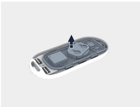
图示：取下遥控钥匙电路板
