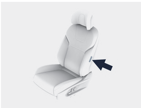
图示：前排座椅侧气囊位置
