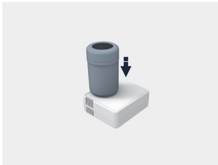
图示：安装补胎液罐
