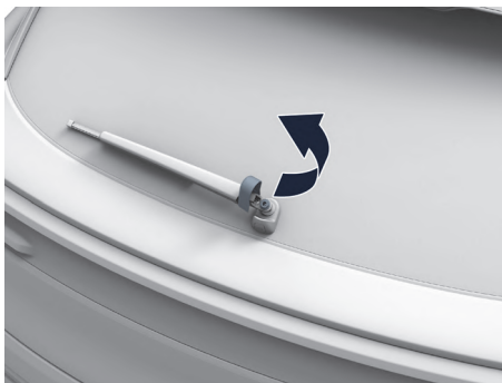
图示：更换后雨刮片
