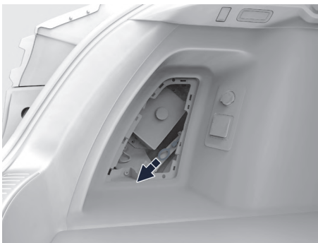
图示：充电枪应急解锁拉线
