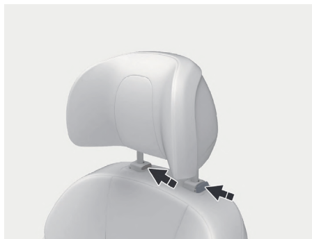
图示：拆卸副驾驶座椅头枕
